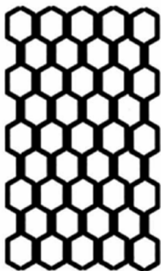
Рисунок Б.2 – Вид пакета пластин при правильной сборке
