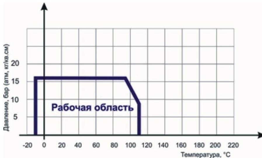
Диаграмма определяет рабочую область для затвора поворотного дискового ABRA-BUV-VF863Dxxx Ду 040-600, Ру 16 в координатах Давление (в барах приборного) / Температура (° C).
