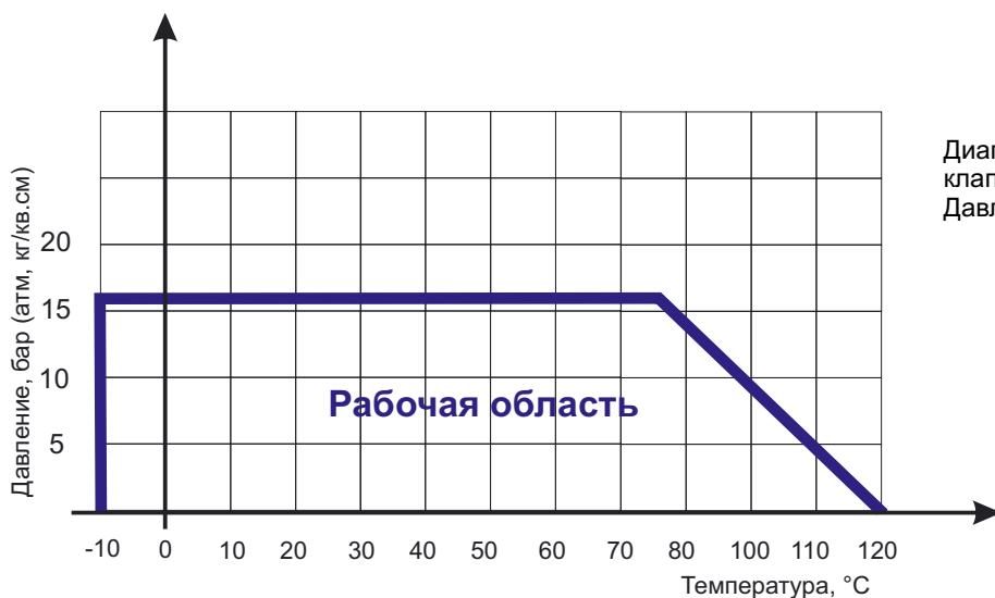
Диаграмма Давление / Температура для клапана обратного ABRA-D-122
