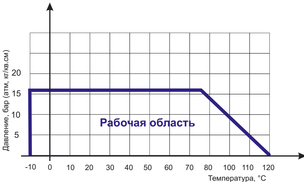
Диаграмма Давление / Температура для задвижки клиновой ABRA-A40-16G с обрезиненным клином и неподвижным штоком Ду40-600 Ру16:
