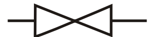
Вариант 2. Знак "Вентиль проходной". Шаровой кран так обозначать неверно, но обозначают так часто.
