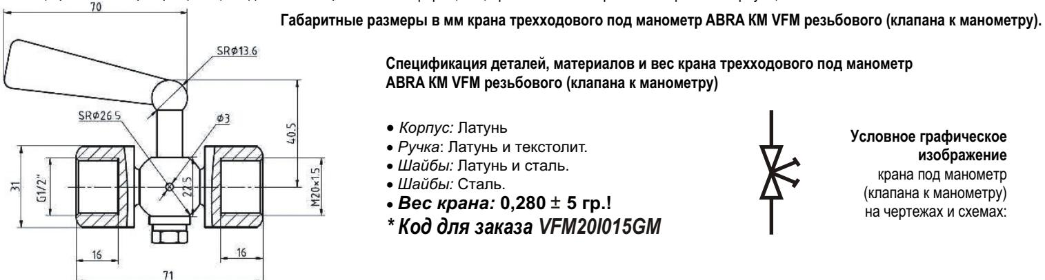
**Описание присоединительной резьбы G1/2"крана трехходового под манометр ABRA VFM резьбового (клапана к манометру)**
