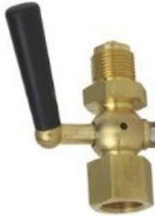
Правила устройства и безопасной эксплуатации сосудов, работающих под давлением, в частности, требуют: "Перед каждым манометром должен быть установлен трехходовой кран или другое аналогичное устройство для продувки, проверки и отключения манометра". Если при соединении с атмосферой стрелка падает до нуля, то вероятность отказа манометра (залипания стрелки) считается минимальной.
