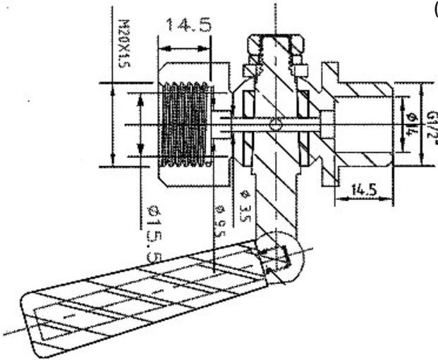
**Спецификация деталей, материалов и вес крана трехходового под манометр ABRA KM VFM резьбового (клапана к манометру)**
