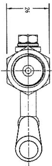
Условное графическое изображение крана под манометр (клапана к манометру) на чертежах и схемах:
